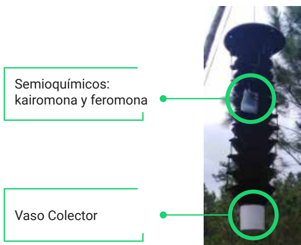
Fig. 9. Trampa multiembudos con sus componentes
